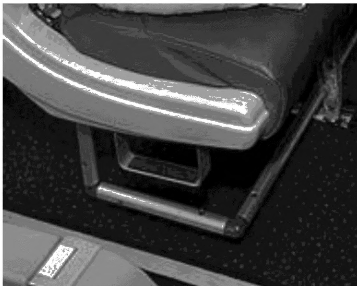
Рисунок 4 — Пример петли-ступеньки в виде стремени, конструкция которой обеспечивает приемлемое расположение ноги
