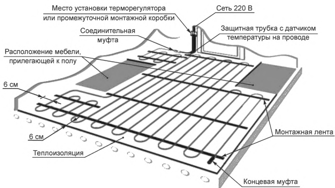
Рисунок Г.2 — Схема укладки кабельной нагревательной секции в помещении
