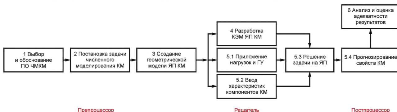
Рисунок 1 — Общий алгоритм проведения численного моделирования
