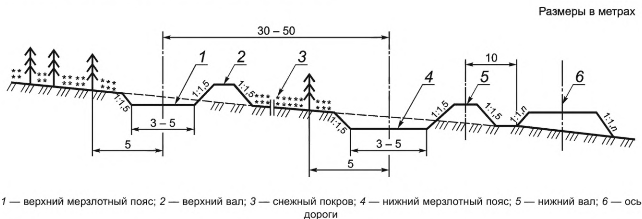
Рисунок 22 — Схема расположения мерзлотных поясов относительно дороги
