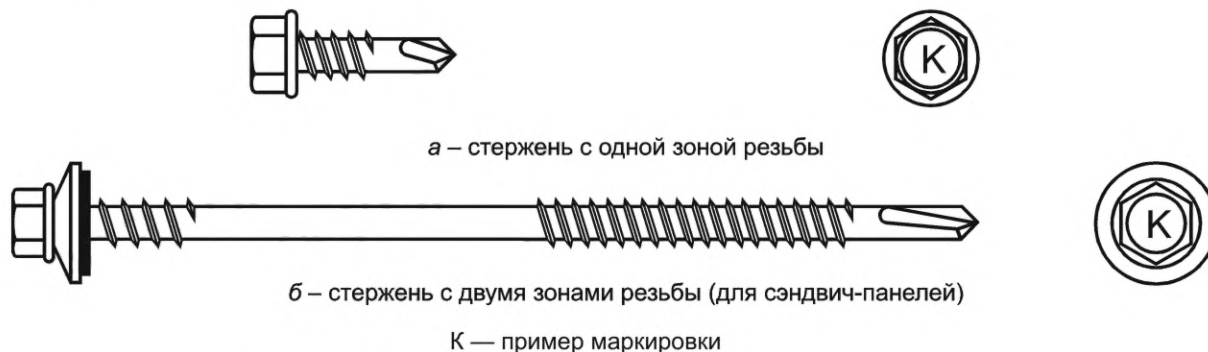
Рисунок 1 — Конструктивное исполнение винтов по типу стержня
