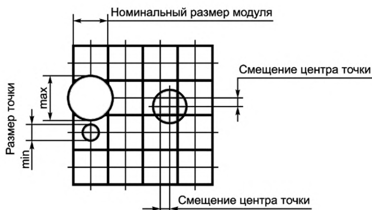
Рисунок 3 — Схема определения номинального размера модуля, смещения центра точки и размера точки
