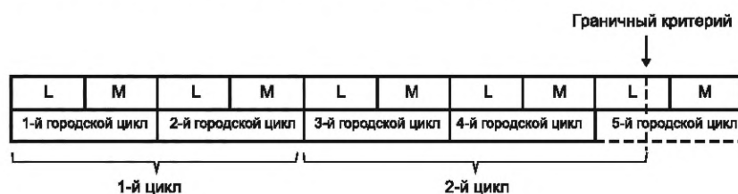
Рисунок Д.4 — Пример четного количества завершенных городских испытательных циклов, предшествующих городскому циклу, в ходе которого выполняется граничный критерий
