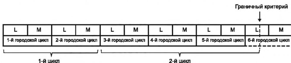
Рисунок Д.5 — Пример нечетного количества завершенных городских испытательных циклов, предшествующих городскому циклу, в ходе которого выполняется граничный критерий
