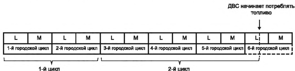
Рисунок Д.3 — Пример нечетного количества завершенных городских испытательных циклов, предшествующих городскому циклу, в ходе которого ДВС начинает потреблять топливо
