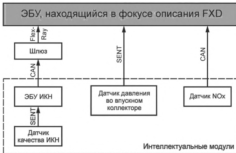
Рисунок С.3 — Взаимодействие интеллектуальных модулей с ЭБУ
