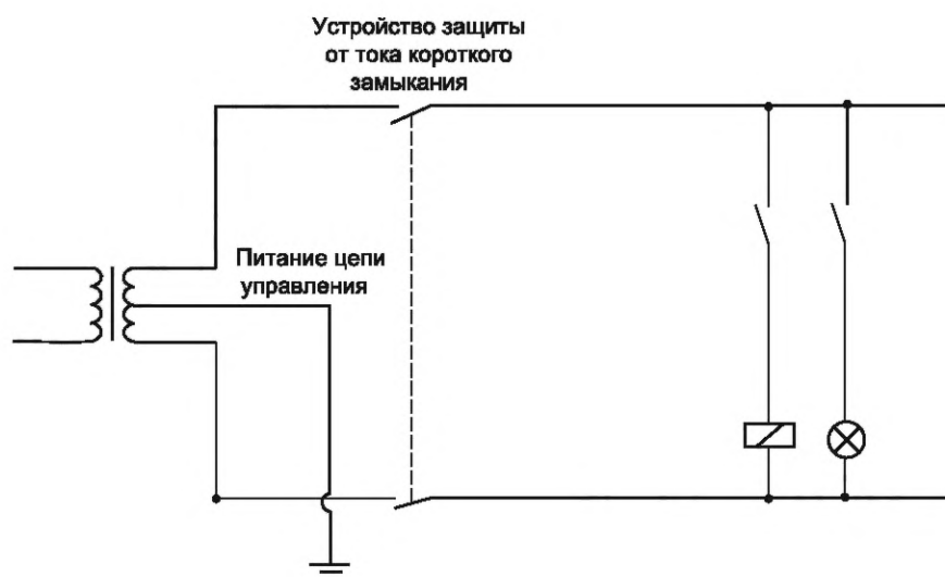
Рисунок 5 — Защита от ошибочных коммутационных операций из-за замыканий на землю для цепей управления, подключенных к трансформатору управления с выведенной средней точкой обмотки
