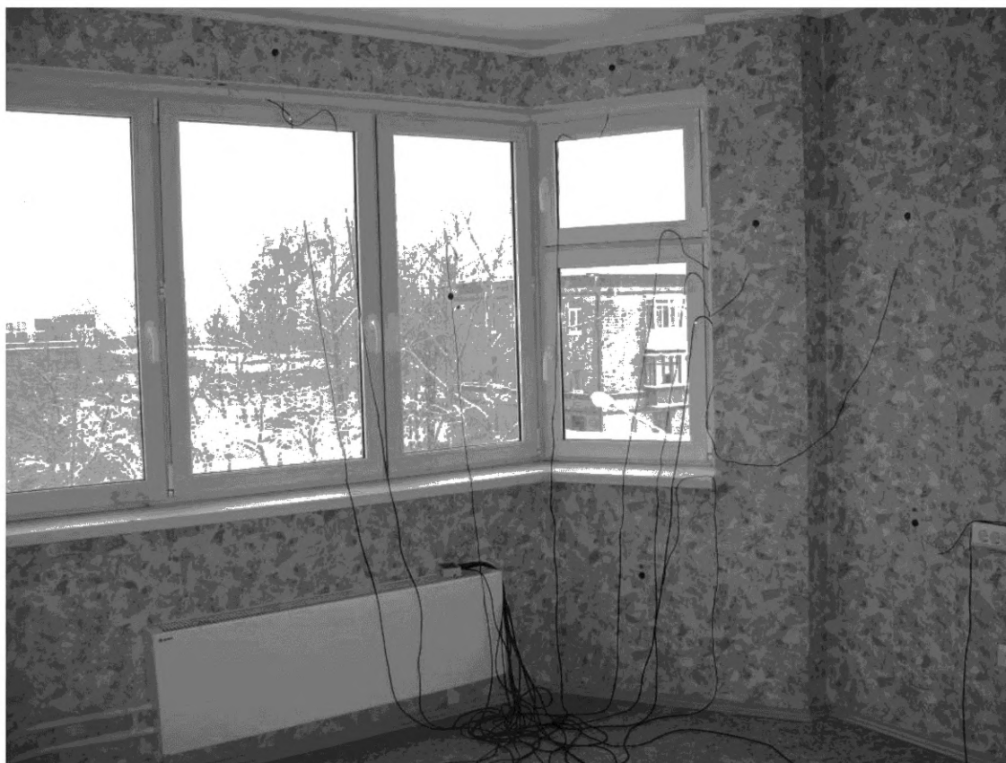
Рисунок А.1— Внешний вид наружной ограждающей конструкции, выбранной для проведения натурных испытаний (вид изнутри)
