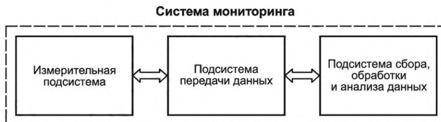
Рисунок 1 — Обобщенная структурная схема системы мониторинга
