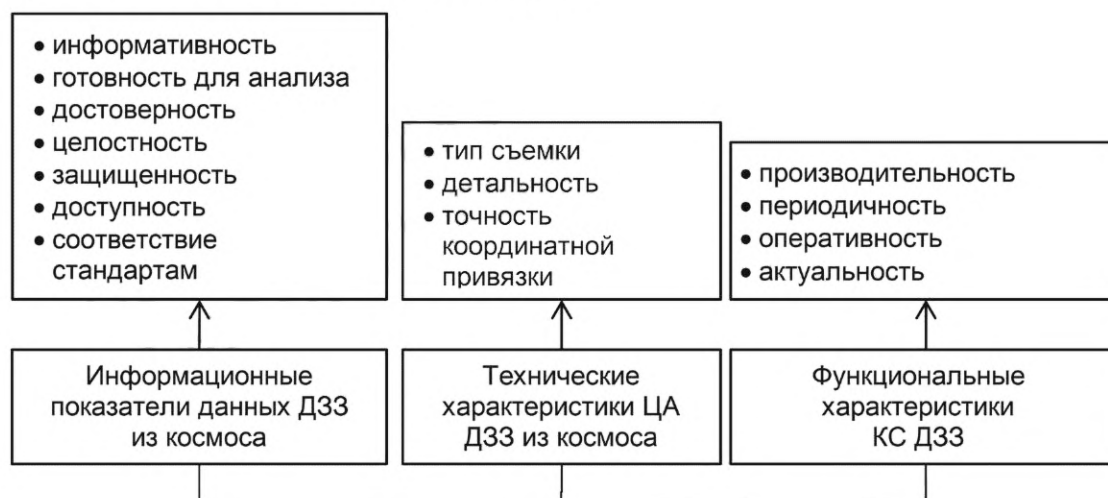
Рисунок 1 — Потребительские характеристики данных, получаемых с КА ОЭН в ВИК диапазоне
