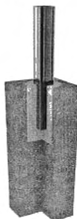
в) С заглублением в грунт Рекомендуется бетонирование
