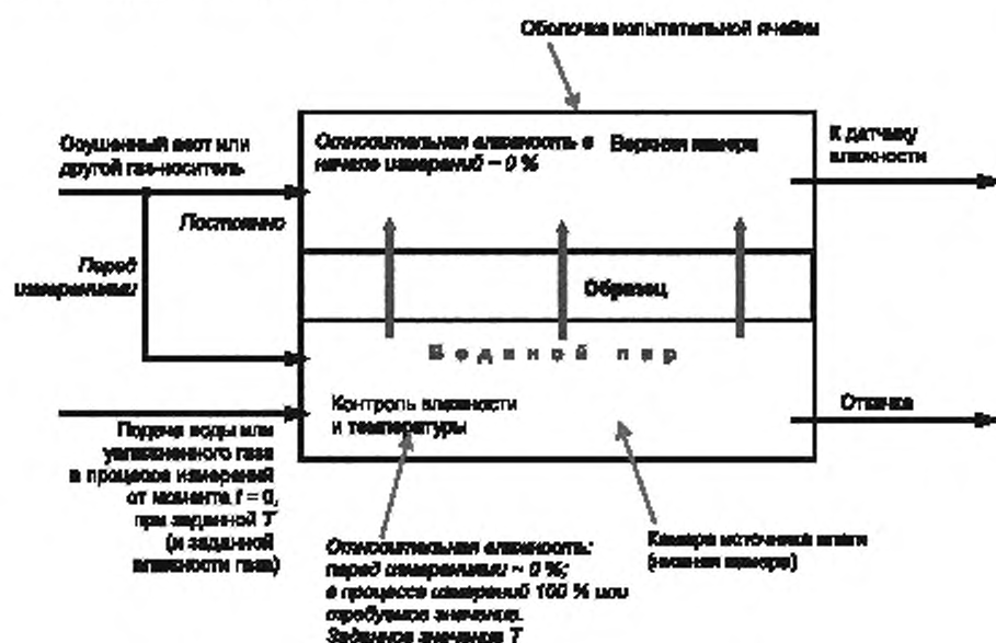
Рисунок 1 — Схема принципа действия испытательной ячейки
