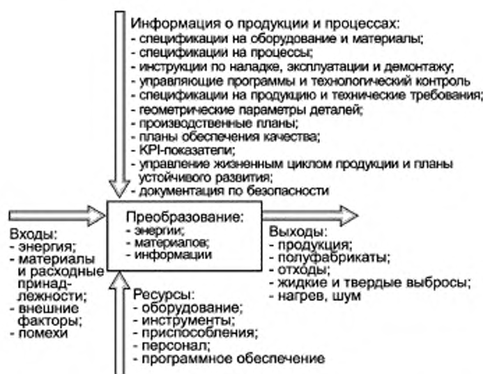
Рисунок 3 — Графическое представление информации о ЕПП-процессе
