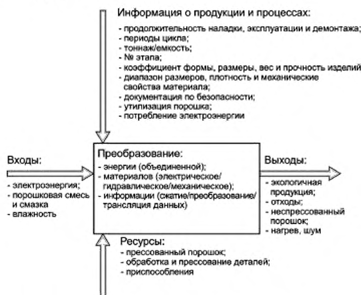
Рисунок 5 — Графическое представление конкретной ЕПП-модели процесса уплотнения порошковой массы
