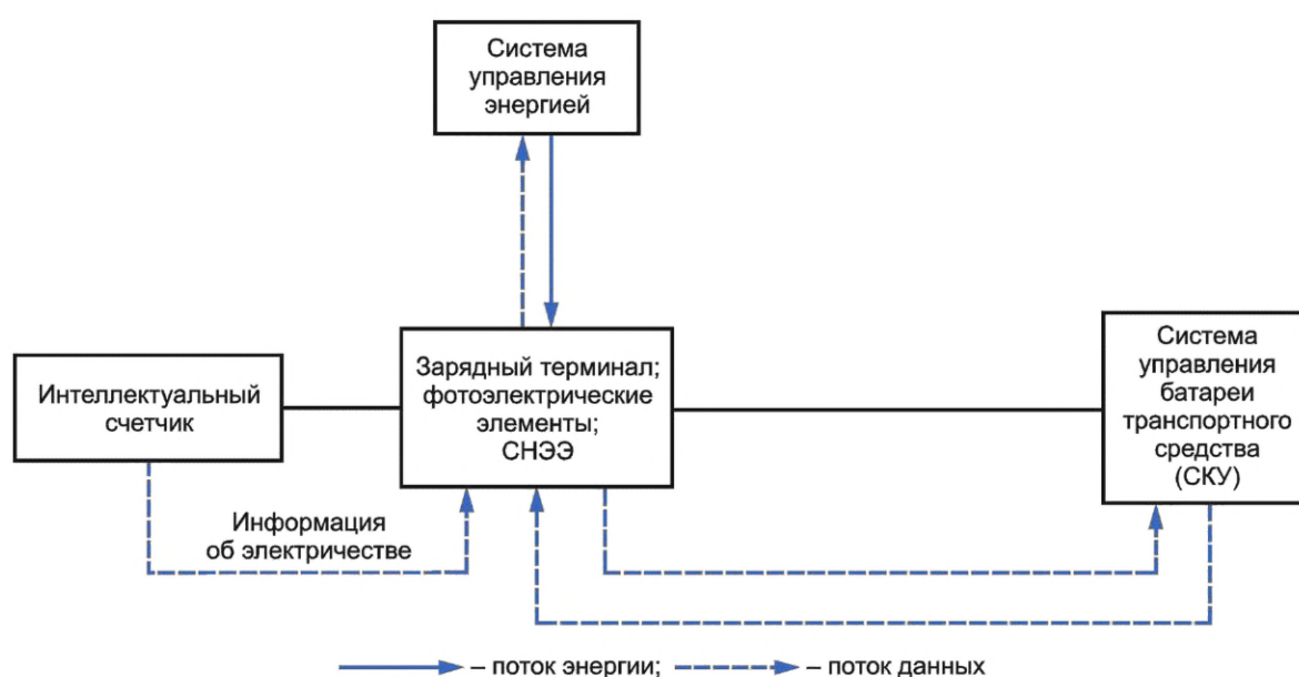
Рисунок 41 — Пример архитектуры системы мониторинга зарядных станций с ВИЭ и СНЭЭ
