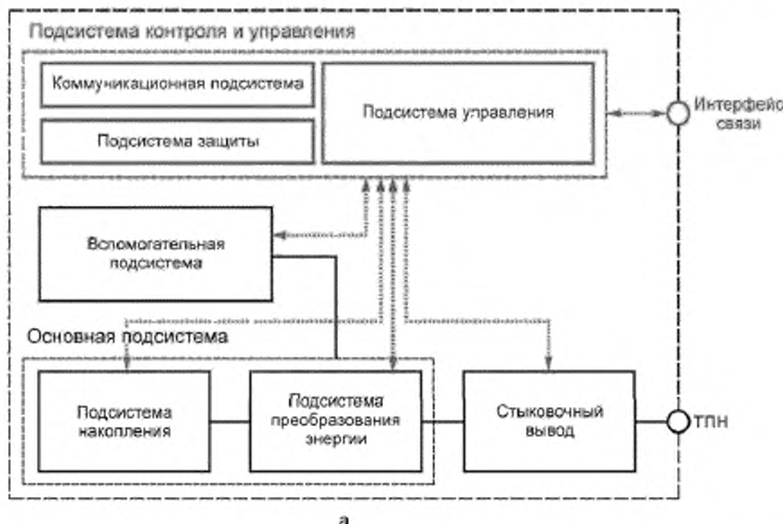
Рисунок 1, лист 1 — Типовая архитектура СНЭЭ без вспомогательной ТПН (а) и со вспомогательной ТПН (б)
