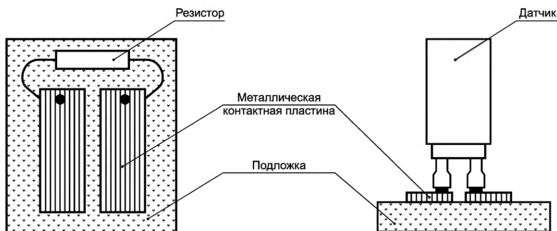
Рисунок А.3 — Устройство для проверки измерителя сопротивления
