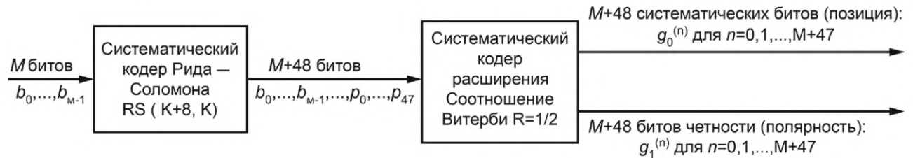
Рисунок 12 — Процесс кодирования FEC
