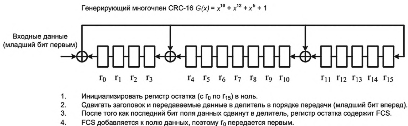
Рисунок 16 — Типовая реализации последовательности FCS
