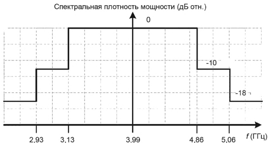
Рисунок 15 — Маска спектра передаваемого сигнала для канала 4
