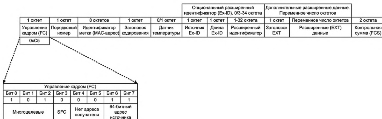
Рисунок 19 — Кодирование кадра блинк-посылки с идентификатором по [18]
