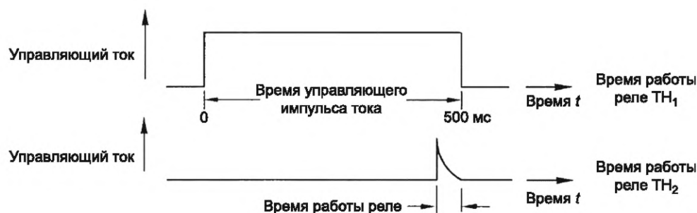
b) временной режим тиристоров T1 и T2
