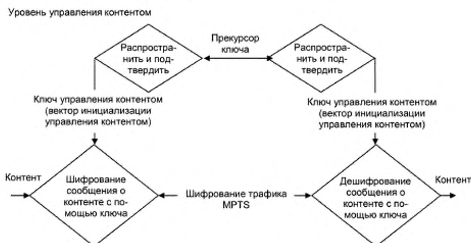
Рисунок 5 — Схема процесса формирования ключей уровня управления контентом
