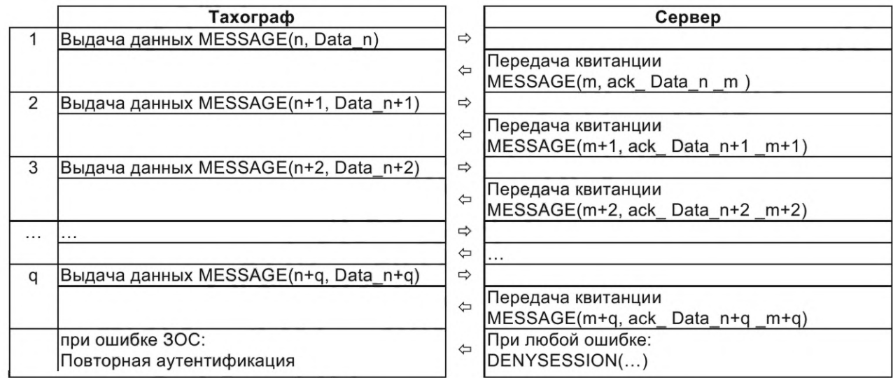
Рисунок 2 — Схема обмена сообщениями тахографа и сервера
