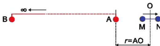
Рисунок 7 — Схема установки точечных электрических зондирований
