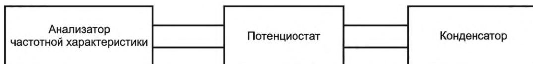
Рисунок В.1 — Система измерения емкости методом переменного тока на низкой частоте
