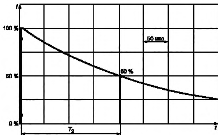
Рисунок В.4 — Кривая хвоста тока первого отрицательного импульса
