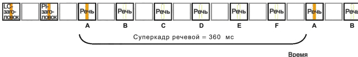
Рисунок 27 — Речевое инициирование с заголовками LC и PI
