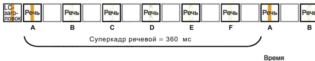
Рисунок 25 — Речевое инициирование с LC-заголовком
