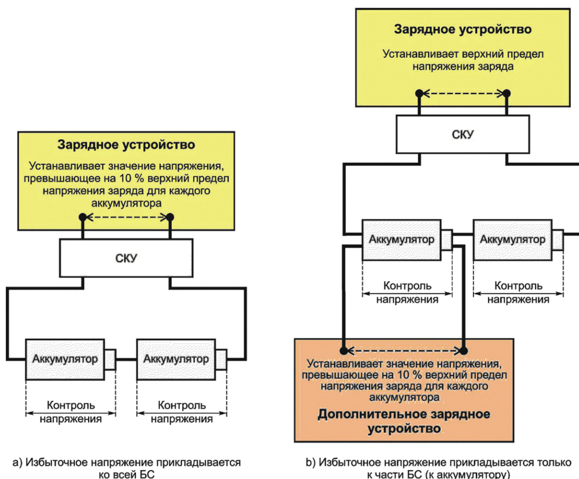
Рисунок 7 — Пример конфигурации схемы управления напряжением при перезаряде
