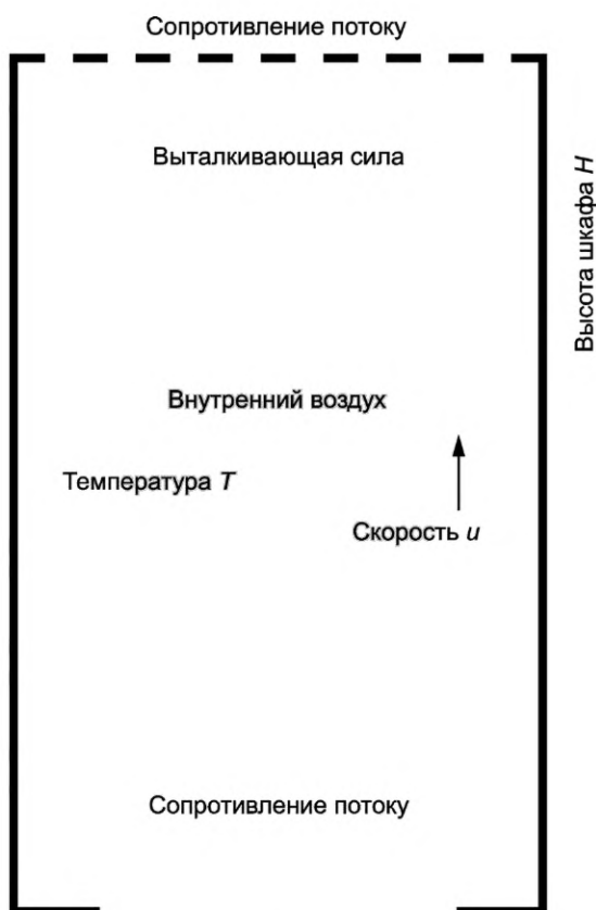
Рисунок А.1 — Уравнивающие силы воздуха внутри шкафа
