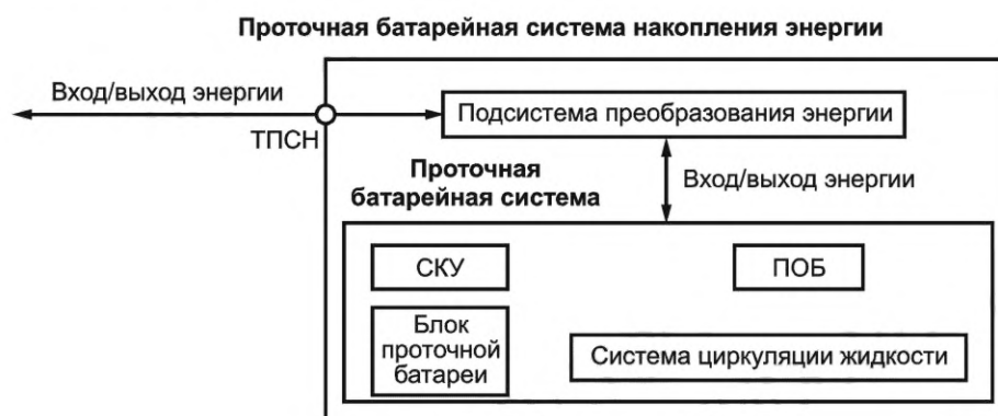
Рисунок 1 — Пример архитектуры СНЭБП
