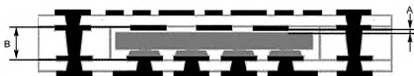
Рисунок 1 — Измеряемые компоненты структуры с микрошлифом отверстия
