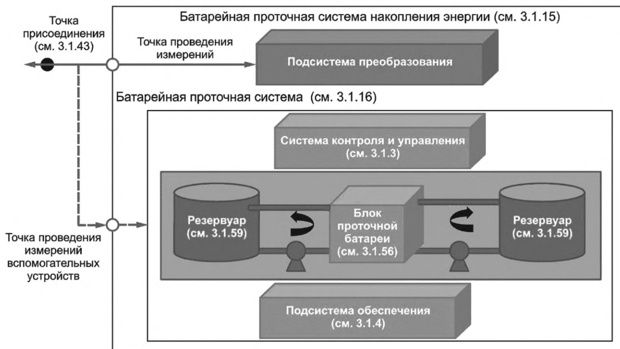
б) СНЭБП с двумя ТПСН
