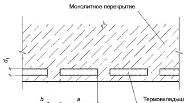
Рисунок 1 — Принципиальная схема устройства термовкладышей в монолитном диске перекрытия (план)
