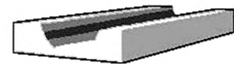
Рисунок 3 — Удаление материала и формирование микроуглублений
