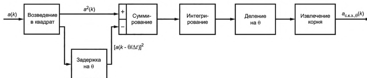
Рисунок D.1 — Метод линейного усреднения
