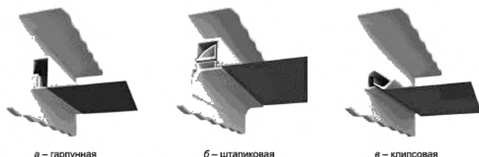
Рисунок 1 — Системы крепления полотна натяжного потолка
