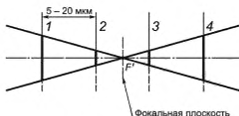
Рисунок 11 — Схема образования плоскостей фокусировки
