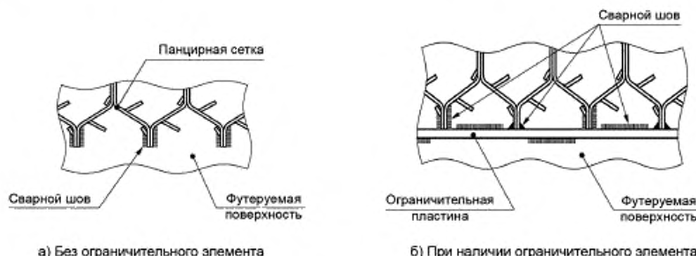
Рисунок 9 — Варианты приварки свободных концов панцирной сетки
