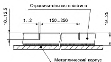
Рисунок 4 — Пазы в ограничительной пластине однослойной футеровки
