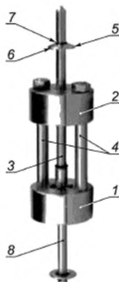
1 — основание, 2 — верхняя платформа; 3 — подвижной стержень, 4 — стойки-колонки; 5 — универсальная опора; 6 — кольцо; 7 — С-зажим; 8 — стержень-подвеска
