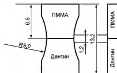
Рисунок А.4 — Размеры образца мини-версии Dumbbell [4]
