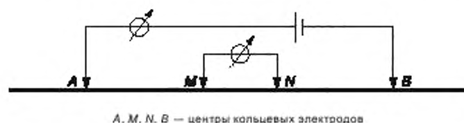
Рисунок А.2 — Электрическая (симметричная четырехэлектродная) схема электрокаротажного модуля зонда
