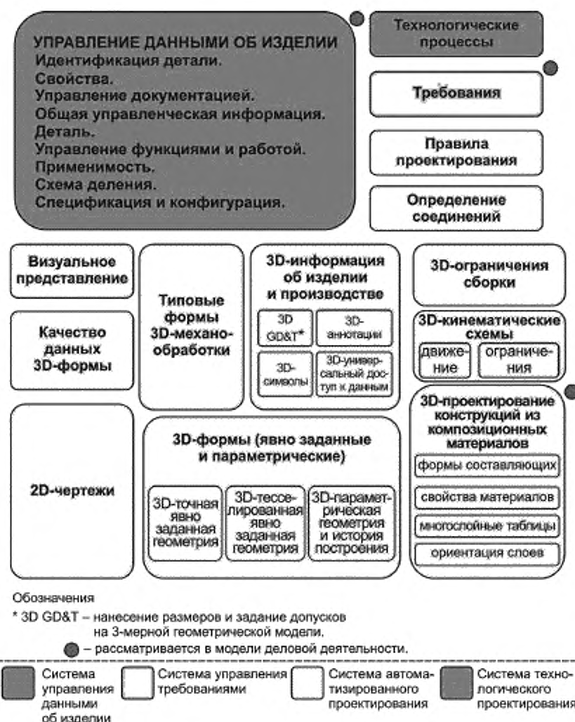
Рисунок 2 — Обзор информационной модели для управляемого проектирования на основе трехмерной модели
