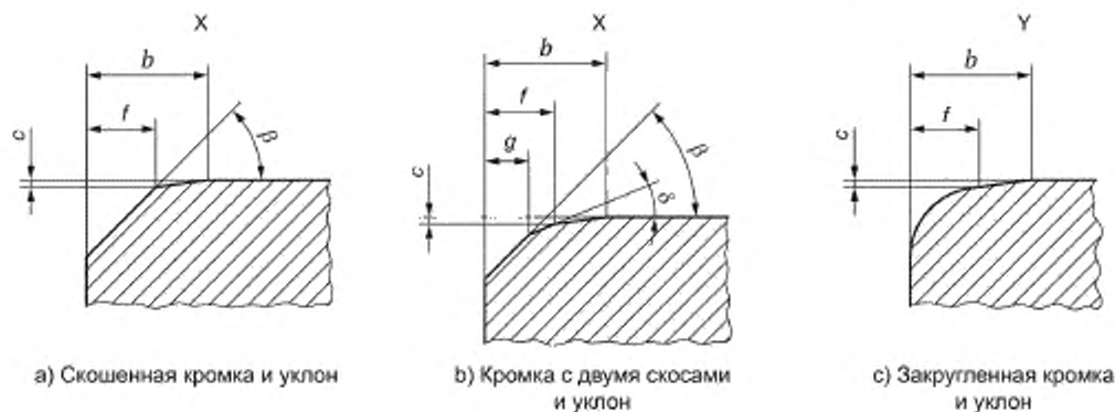
Рисунок 12 — Варианты уклона (выносные элементы X и Y рисунка 6)
