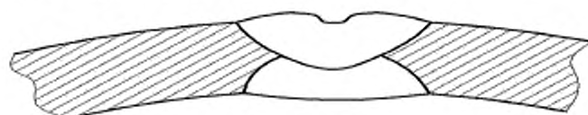
а) Усадочная раковина при дуговой сварке
