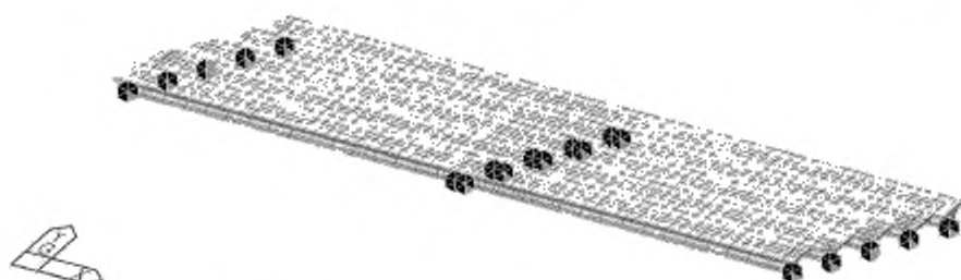
Рисунок В.7 — Общий вид расчетной схемы при угле косины 60^\circ
