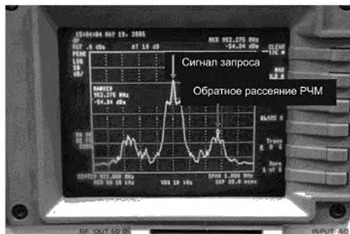
Рисунок 34 — Измерение обратного рассеяния радиочастотной метки
