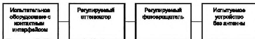
Рисунок 4 — Испытательная установка с контактным соединением
