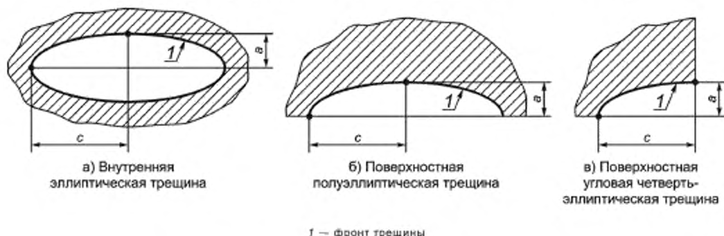
Рисунок 9.1 — Виды расчетного дефекта в элементах ВКУ
