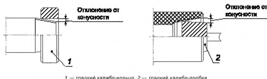
Рисунок 4 — Проверка конусности резьбы гладкими калибрами
