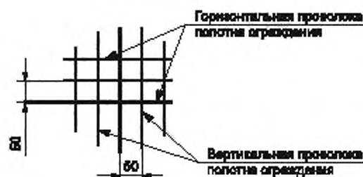
Рисунок Б.2 — Полотно ограждения с прямым профилем горизонтальной проволоки
