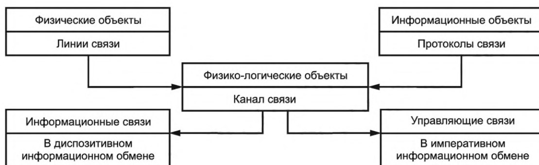
Рисунок 4 — Образование информационных и управляющих связей
