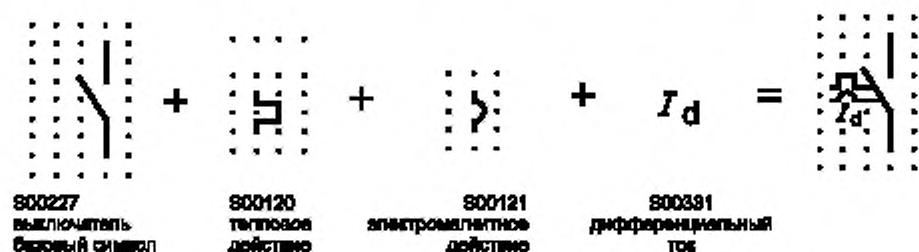
Рисунок А.8 — Символическое представление автоматического микровыключателя с устройством остаточного тока, вариант 2
